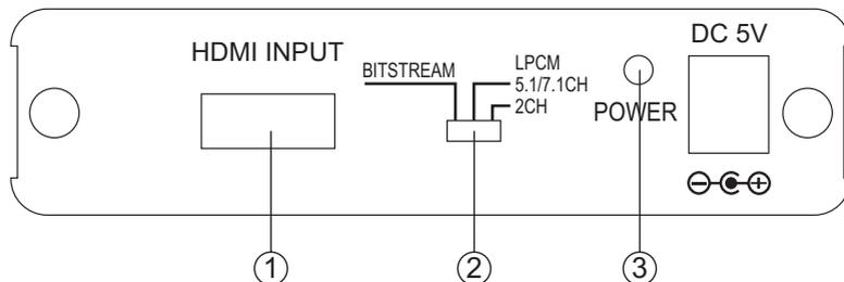
1. HDMI Eingang: Verbinden Sie den HDMI Eingang des Verstärkers und den HDMI Ausgang des Endgerätes ( DVD Player, Digialempfänger) über ein HDMI Kabel.
