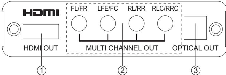
1. HDMI Ausgang: Verbinden Sie den Ausgang des Repeaters über ein HDMI Kabel mit dem Endgerät (z. B. Fernseher).
